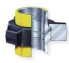
高压由壬引进国际先进技术,采用高强度合金钢锻造而成,严格的热处理确保接 头有均匀一致的金相组织和承压能力,所使用材料完全符合美国ASTM和AISI标准, 产品技术指标完全符合API Spec 16c 标准,产品密封可靠,装卸快捷、通用互换 性好。产品接头可用管线螺纹、油管螺纹、对焊式或无压密封端部连接。 The connecting surface of precise linear seal ensures reliable pressure sealing. Application is recommended for low-pressure manifold and operating pressure at maximum 1,000 psi.
